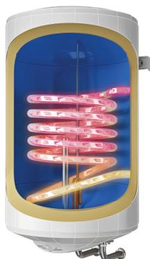
Le **TURBULATEUR** est un élément métallique équipé d'ouvertures spéciales, intégré sur toute la longueur du tube de l'échangeur de chaleur. Il casse le cœur chaud du fluide circulant dans l'échangeur de chaleur, augmentant ainsi l'efficacité du transfert thermique vers l'eau située à l'intérieur du réservoir.
